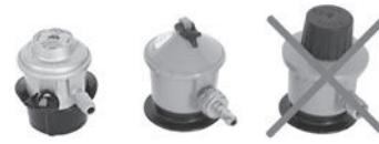
Kuvassa 30 mbar matalapainesäätimet, jotka ovat oikea valinta kaasugrillille sekä oikealla korkeapainesäädin, joka on tarkoitettu nestekaasutyökaluiille eikä sitä saa käyttää kaasugrillissä.
